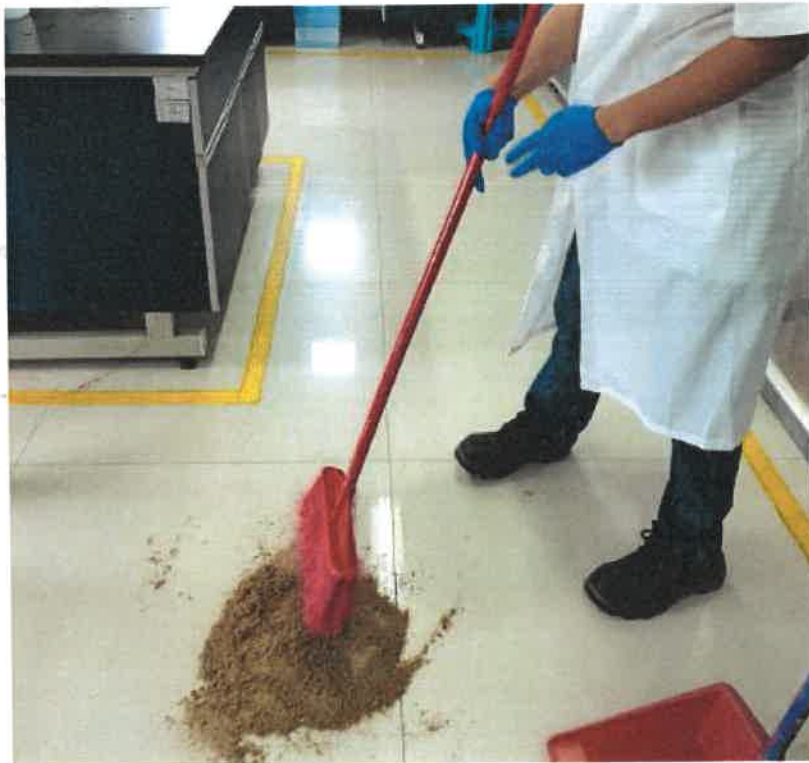
图 1：化验员对泄漏点进行覆盖
